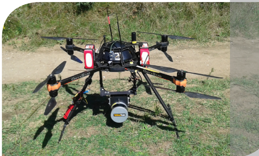
Drone téléguidé en campagne Lidar © L'Avion Jaune - capteur YellowScan
