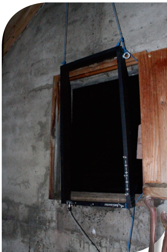
Cadre en aluminium permettant de compter les chauves-souris au moment de leur envol en détectant leur sens de passage grâce à des faisceaux lumineux © F. Billard
