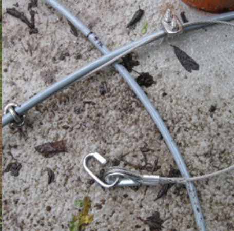
Un câblage suffisant et une accroche fixe sur la tête de puits permettent de maintenir la sonde en place © B. Fritsch (CEN Bourgogne)
