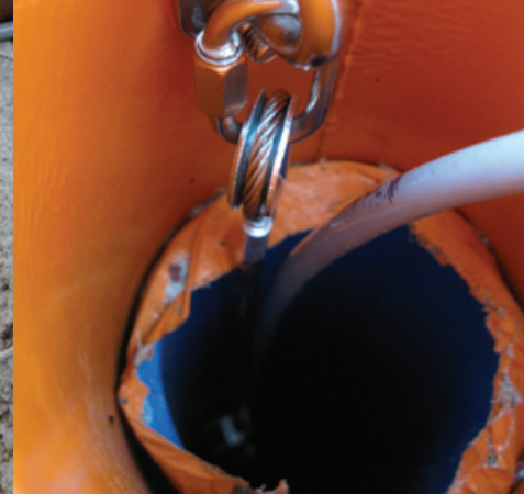
Un câblage suffisant et une accroche fixe sur la tête de puits permettent de maintenir la sonde en place © B. Fritsch (CEN Bourgogne)
