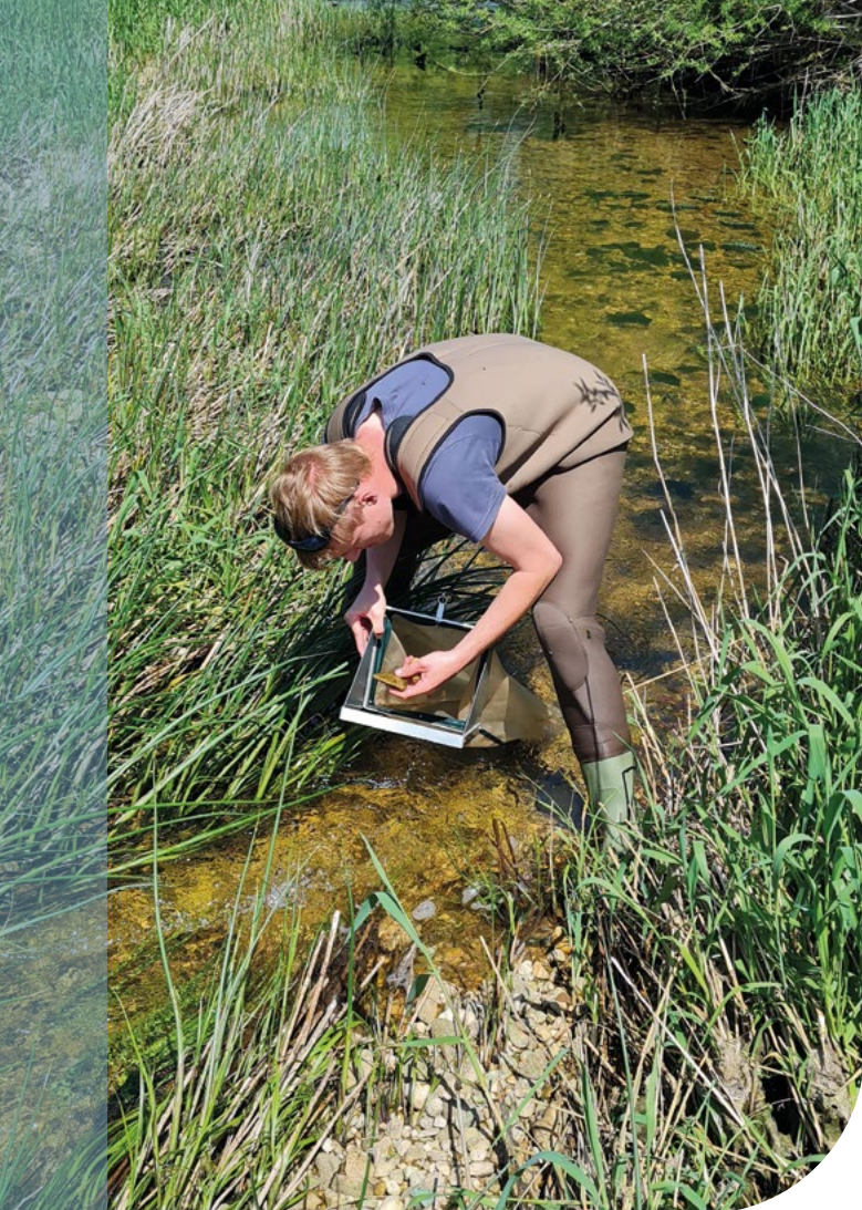
Prélèvement d'une placette de 1/20 e de m 2 à l'aide d'un filet Surber © EPAGE Haut-Doubs Haute-Loue
